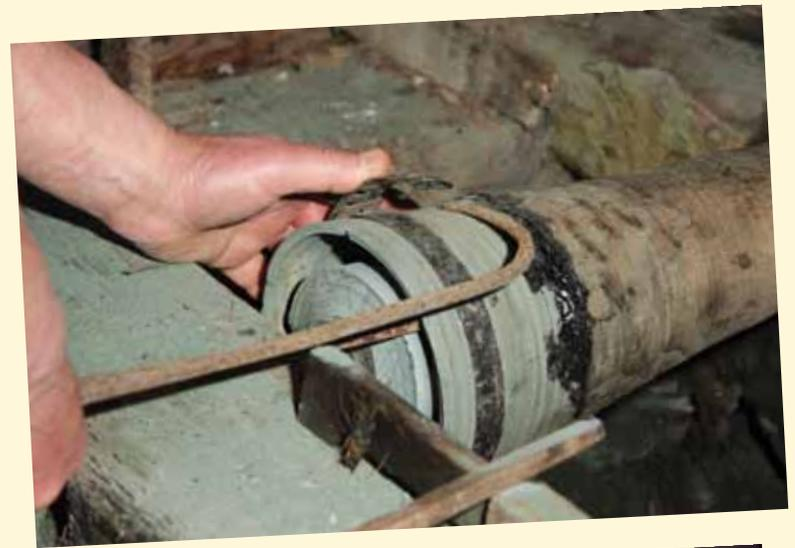
**Sopra a sinistra** - Altra inquadratura dello scavo del "Levèc" con lo "Sciüscèpet" l'utensile con i ferri intercambiabili con i quali si scava il fondo del "Levèc".
